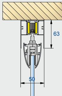
**Montage Schiebetüren mit Designrohr freiliegend**
